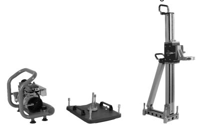
Controllare che la guarnizione della piastra di base del vuoto non sia usurata o danneggiata.
